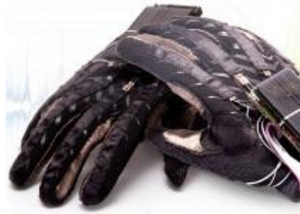
Photo d'une paire de gants Enable Talk pour la conversion langue des signes-texte/parole 36
